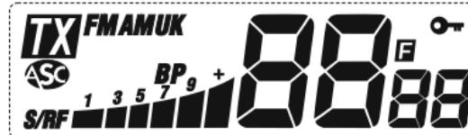
Счетчик отображает уровень приема и уровень выходной мощности.
